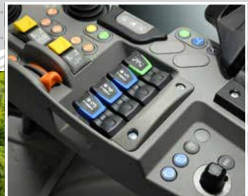
Distribuidores hidráulicos con control electrónico.
