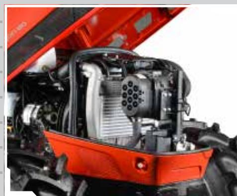
Motores FARMotion, 3 cilindros, Fase III B.
