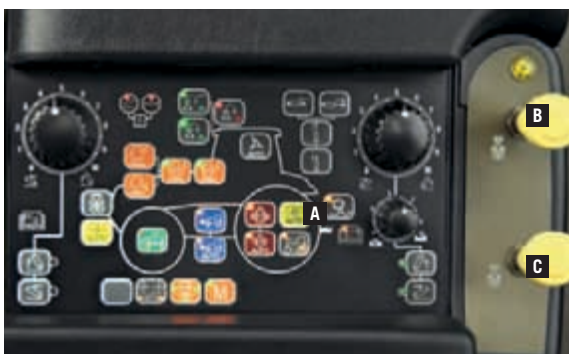
... el Maxxum Multicontroller y Maxxum CVX. A – Mandos de la TDF automática B – TDF delantera activada/desactivada C – TDF trasera activada/desactivada
