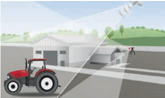
La tecnología xFill™ cubre las interrupciones de señal RTK de hasta 20 minutos.
