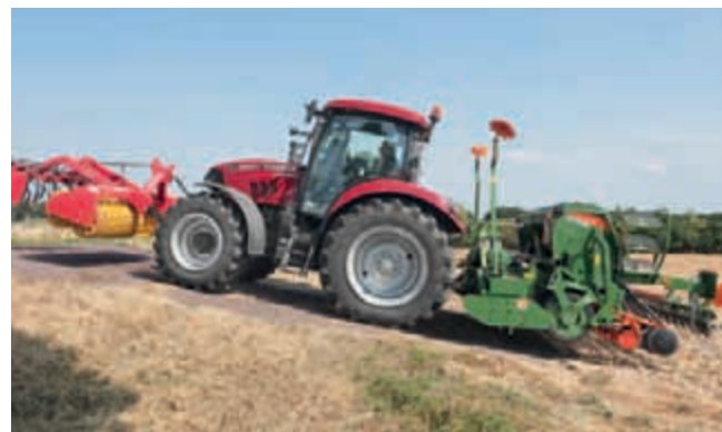
La función «ActiveStop» detiene el tractor en posición fija sin necesidad de utilizar el freno.
