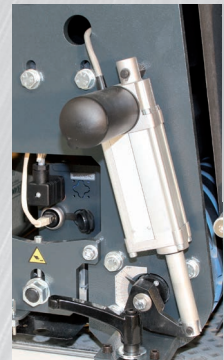
Elektronischer Körnungsausgleich Grit-set électronique Электронное устройство Grit-set для компенсации зернистости шлиф.ленты
