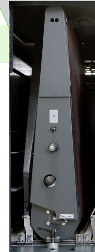
Gruppo rullo ø180 Roller unit ø180 Groupe rouleau ø180
