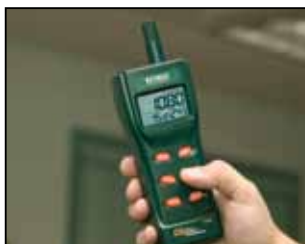
Mide el nivel de CO 2 en edificios de oficinas para asegurar una ventilación adecuada
