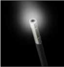
El extremo de cámara incluye luces LED integradas.
