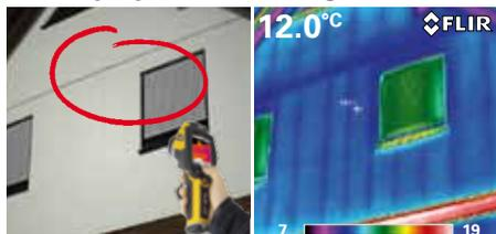
La inspección térmica localiza el aislamiento defectuoso en la pared.
