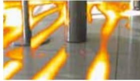
Imagen de fusión térmica de la inspección de un suelo radiante
