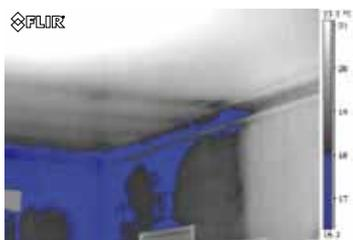
La alarma de humedad relativa alerta sobre las áreas en las que existe riesgo de condensación. En la imagen siguiente, se indica el área en riesgo en color azul.
