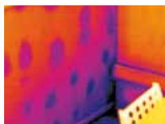
La imagen térmica muestra la presencia de mohos en el interior de una pared debida a la infiltración de agua.
