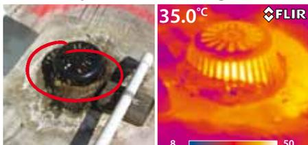
La imagen térmica muestra goteras de agua en el techo.
