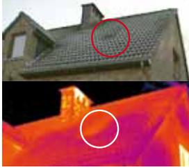
La inspección térmica localiza el aislamiento defectuoso en el techo. Ahora pueden repararse y evitarse posteriores pérdidas de energía.
