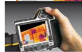
Una pantalla táctil LCD multifuncional permite un desplazamiento rápido y fácil por el menú de la cámara.
