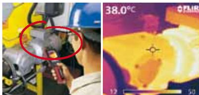
*Verificación mecánica de un motor eléctrico con la i60 de FLIR.*
