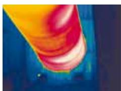
*Rotura del refractante en un horno de cemento giratorio*
