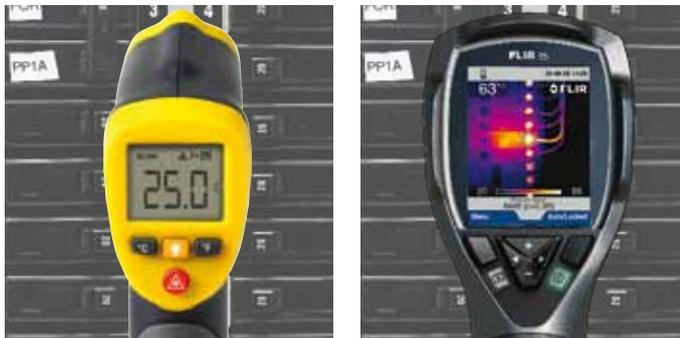
Termómetro infrarrojo, la temperatura en un solo punto FLIR i5, la temperatura en 6.400 puntos
