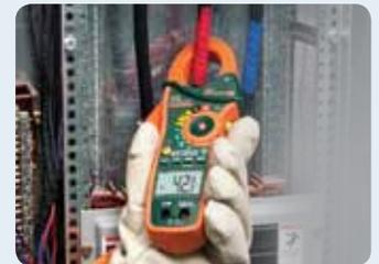
METERLINK™ permite al termógrafo tomar lecturas eléctricas más rápidamente con una pinza amperimétrica Extech EX845 y registrarlas de manera instantánea y directa sobre una imagen infrarroja.
