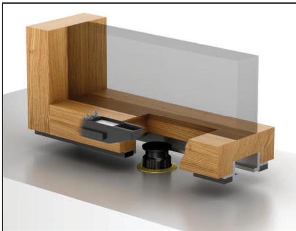
El pasador guía magnético permite mantener un movimiento de deslizamiento lineal. Además, con la hoja en posición cerrada, aumenta la resistencia a la carga del viento y al robo.
