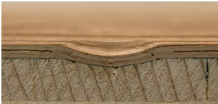
Parquet convencional con capa media de abeto (capa de cobertura de roble de 3,6 mm)
