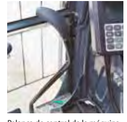
Palanca de control de la máquina con especificación de demolición de alcance elevado situada en la zona de los pies
