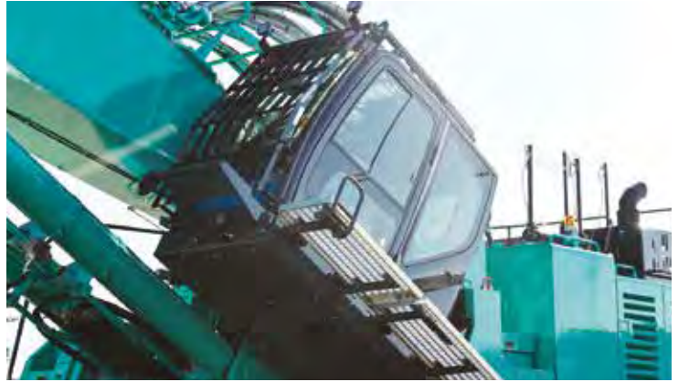
El ángulo de inclinación de la cabina de 30 grados ofrece la posición de observación óptima cuando la aplicación exige largos períodos de trabajo en altura.
