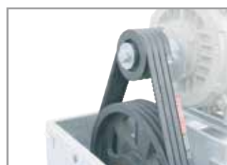
El accionamiento por correas trapezoidales se destaca por su fácil mantenimiento.
