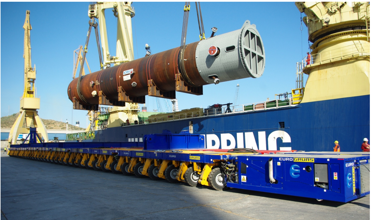
Self Propelled Modular Transport "SPMT" / Equipos modulares autopropulsados SPMT
