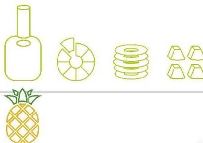
La cortadora y descorazonadora semiautomática de dos cabezales, nace para cortar la piña de forma cilíndrica. Un operario carga el fruto y la máquina efectúa todo el trabajo en tres fases: descorazona, corta parte superior e inferior y corta a cilindro. Además del corte a cilindro, la máquina permite cortar a rodajas, gajos o tacos, según la necesidad del cliente.
