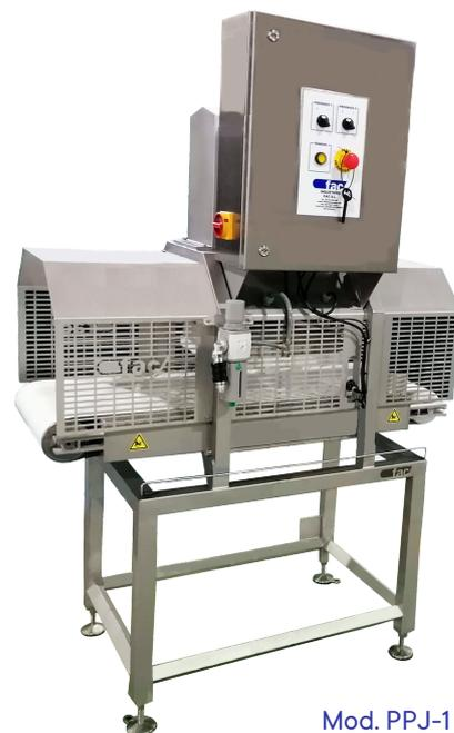
Línea de moldeado del jamón con formadora y prensa
