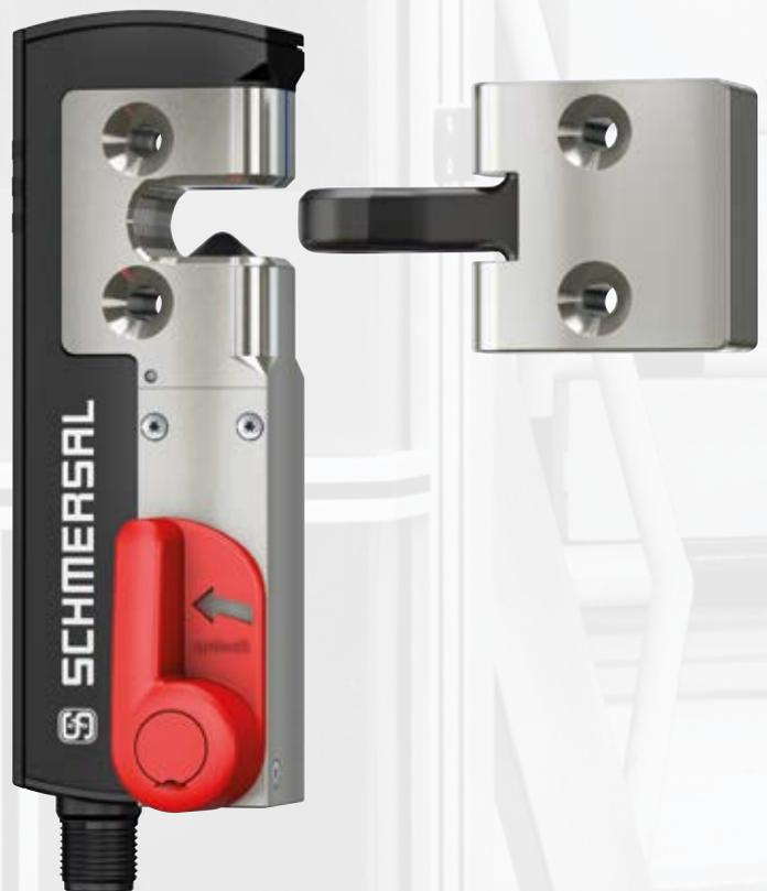
El AZM40 dispone de un principio de bloqueo biestable, que, en caso de fallo de suministro, mantiene el último estado de bloqueo del dispositivo. El resguardo (puerta) de seguridad sigue manteniéndose cerrado con seguridad incluso en el caso de movimientos por inercia peligrosos.
