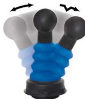
Pulsador/interruptor tipo Joy-Stick Posiciones de conmutación por pulsación y enclavamiento Retorno tocando suavemente y por muelle
