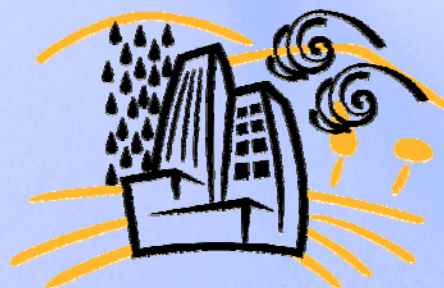
Grado de Impermeabilidad 5: Edificio alto en un entorno rural, en una zona de mucho viento, y de mucha lluvia.
