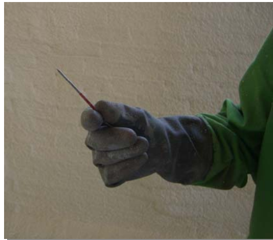
Punzón de no más de 2 mm de diámetro para realizar el ensayo de medición de espesor.
