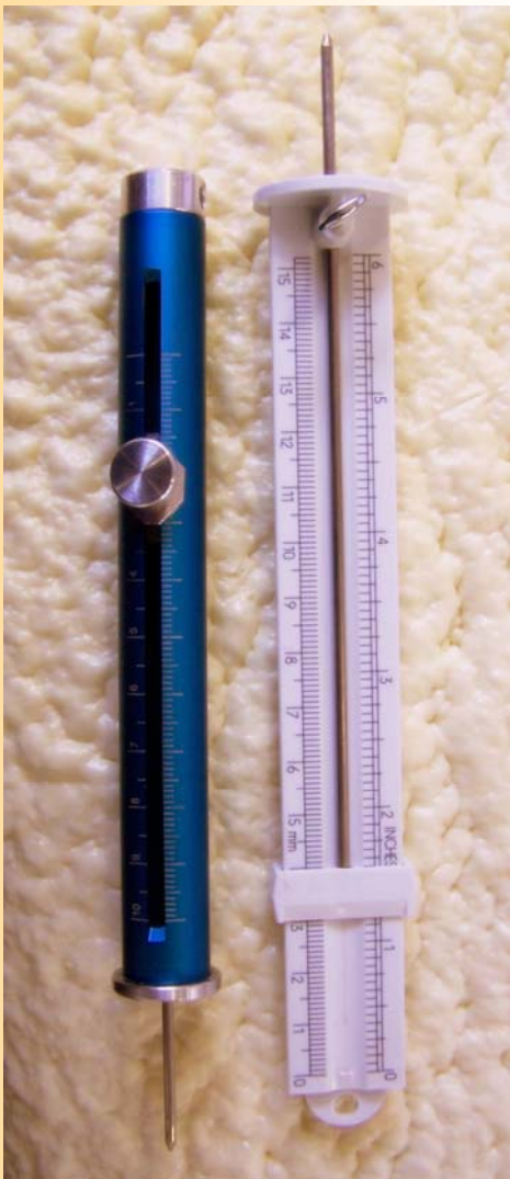
Punzones para medir el espesor del poliuretano proyectado.
