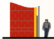
Si el arranque es accesible, la espuma deberá protegerse en los primeros 3,5 m
