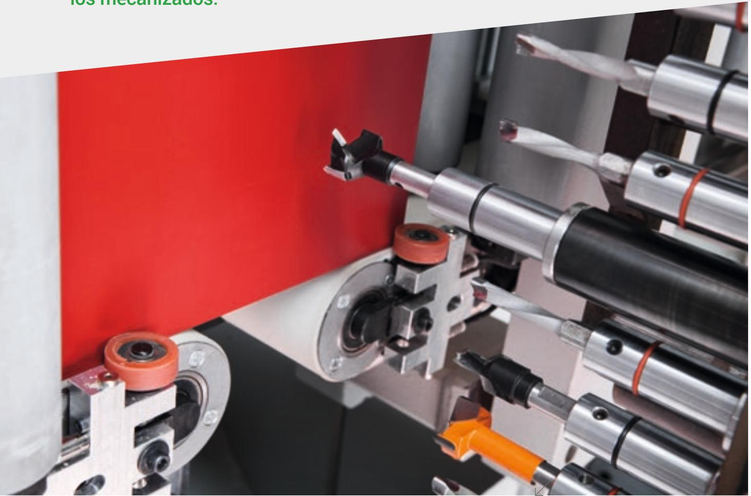
Los mandriles con vástago aumentado permiten realizar todos los mecanizados de taladrado garantizando siempre altos niveles de calidad.
