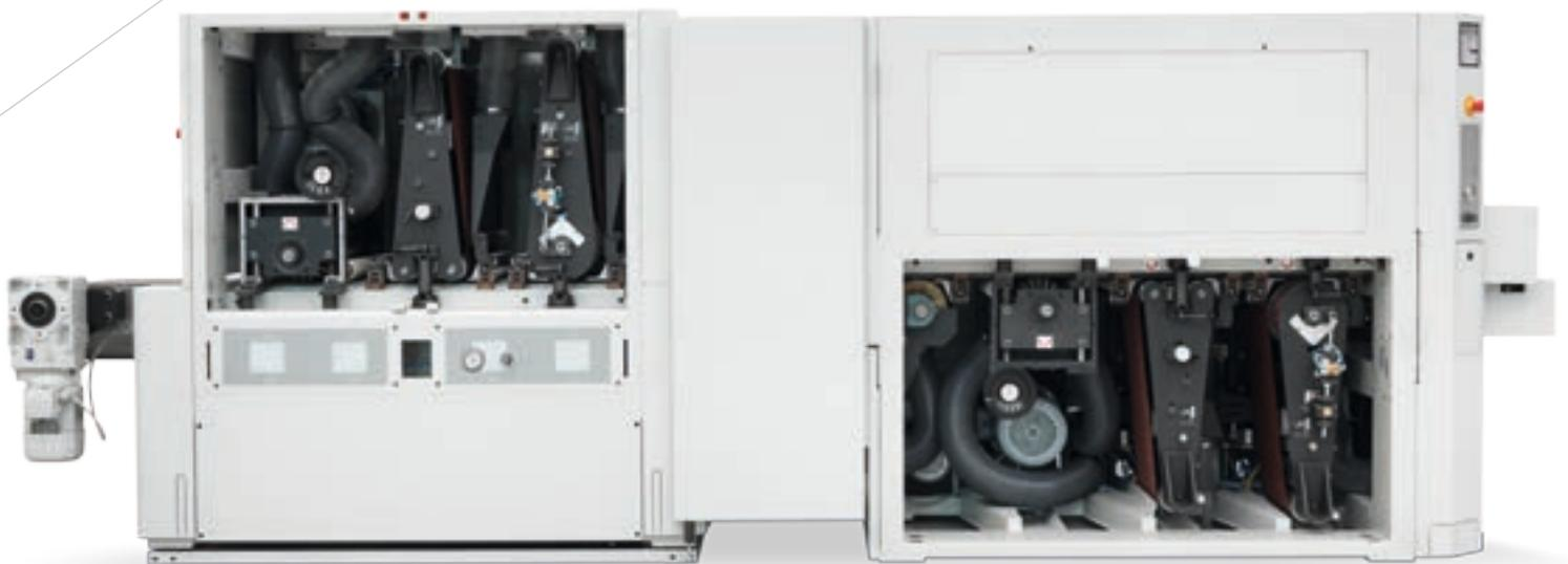
Puede constar de una máquina inferior o superior o en línea de elaboración con las dos máquinas unidas, lo que permite trabajar los dos lados del panel en una única pasada.
