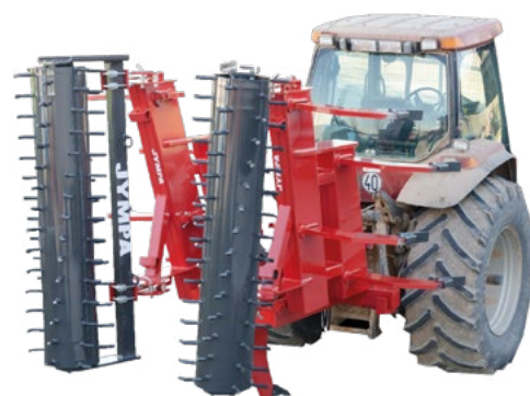
Modelo RIGEL-9-2V-PC con rodillo simple Ø 580 mm
