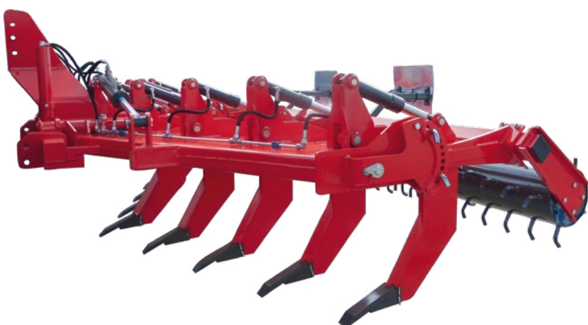
Modelo SPICA-9-PC con rodillo simple Ø 580 mm
