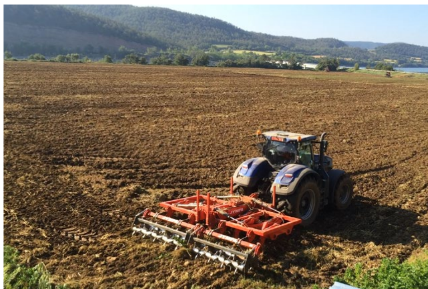
Modelo POLARIS-7 con rodillo doble \varnothing 520 mm con regulación mecánica
