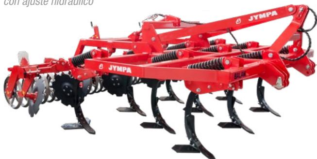
Modelo BALAM-PRO-3010 con rodillo de ángulo  $\varnothing$  580 mm con ajuste hidráulico
