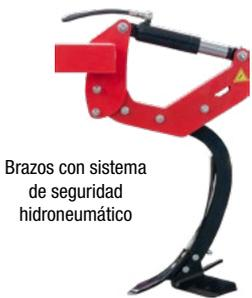
Brazos con sistema de seguridad hidroneumático
