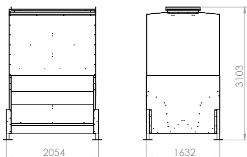
A092-2M-1S Volumen útil: 7m 3 . Capacidad aprox.: (600kgs/m 3 )= 4.200 kgs
