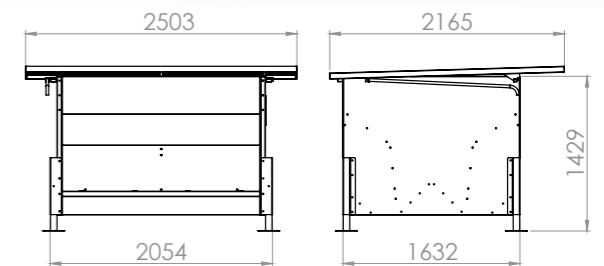
A091-2,5M Volumen útil: 4m 3 . Capacidad aprox. (600kgs/m 3 )= 2.400 kgs
