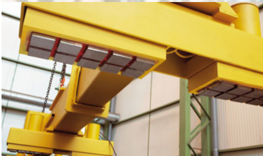
Módulos magnéticos monobloque con sistema elástico de suspensión para adaptarse a la morfología de la carga.
