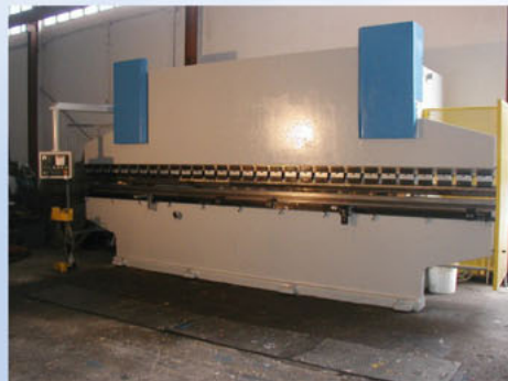
Pareja de Cizalla Descombes de 6000 x 4 y Plegadora Durma HAP 60200 de 6000 x 200 Tn. Marcado CE.
