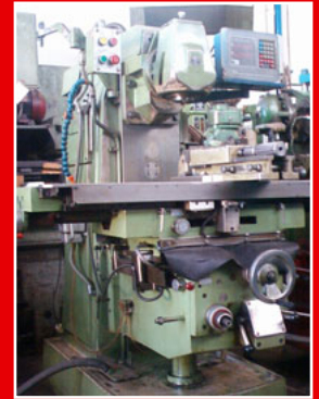
Fresadora universal FEXAC, UM, con digitales Fagor a 2 ejes
