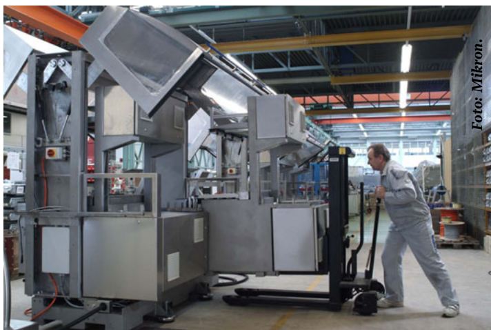
Mikron se concentra desde hace 15 años en la fabricación de plantas de montaje de alta velocidad con módulos estandarizados. En la actual plataforma Go5 pueden sustituirse o ampliarse de manera muy sencilla los diferentes módulos.
