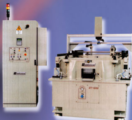
Máquina vertical para prueba de sobre velocidad y explosión
