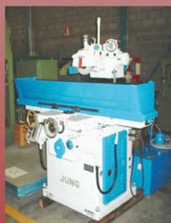
Rectificadora H. JUNG Palto Mag.500x200 mm.
