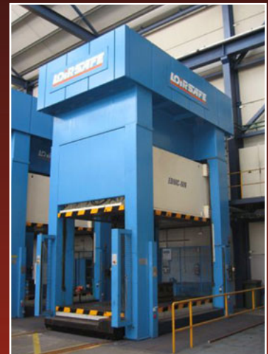
PRENSA LOIRE EDIMC 800-300, fuerza 800 t., mesa 4.900x2.500, 200 cv., hidráulica simple efecto superior
