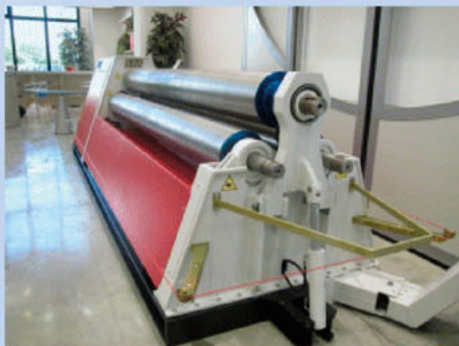
Cilindro DAVI mod. MCO3028 de 3050 x 10/13 mm. Marcado CE.
