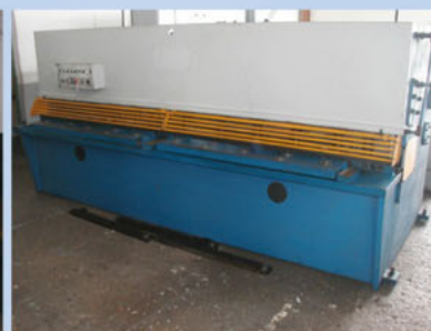
Pareja plegadora BARRY GC-3135 de 3000 x 135 Tn control DNC 60 y Cizalla SC-3006 de 3000 x 6 mm. Año 2007.
