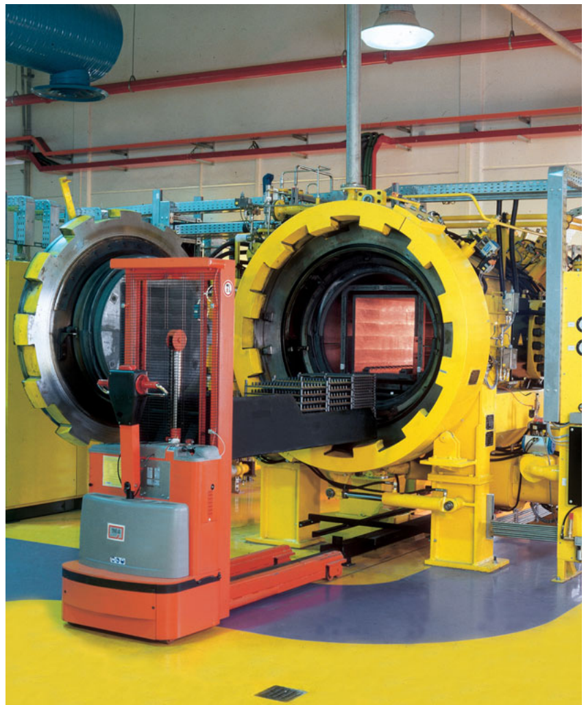
Robots filoguiados realizan la carga y descarga de los hornos de sinterizado sin intervención humana. El objetivo es eliminar cualquier tipo de contaminación.
