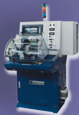
Equilibradora horizontal de piezas autopropulsadas
