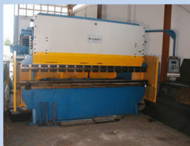
Pareja plegadora BARRY GC-3135 de 3000 x 135 Tn control DNC 60 y Cizalla SC-3006 de 3000 x 6 mm. Año 2007.
