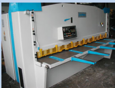
Cizalla DURMA mod. AHGM3010 de 3100 x 10 mm. Marcado CE.
