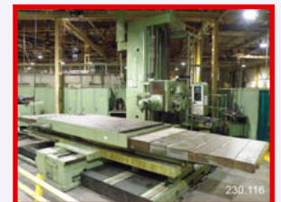
Mandrinadora fresadora horizontal CNC SACEM mod. MSTL-130 A-C
