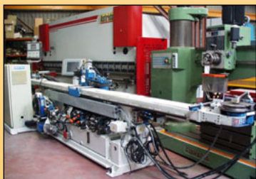
CURVADORA DE TUBOS BEMA REKORD CNC 32 D-S DE 5 EJES CONTROLADOS
