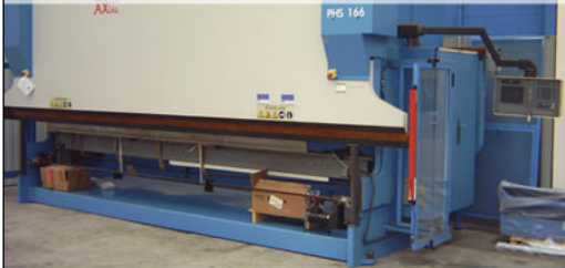
Plegadora AXIAL PHS-166, 160 Toneladas Control DNC 84 PS. Longitud 6.080 m/m
