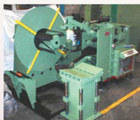
Devanadera-Enderezador-Cortador 5Tn.x 500x3mm.
