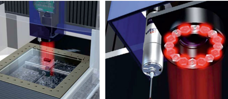
Un puntero de láser coaxial facilita la navegación durante la programación.
