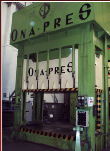
PRENSA ONA-PRES EMD-625, fuerza 625 t., mesa 3.820x1.500, 87 cv., hidráulica
