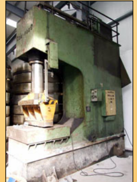
PRENSA HIDRÁULICA ONA PRESS 400t
