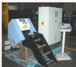
Alimentador Electrónico ARKU 300 x 5 mm.
