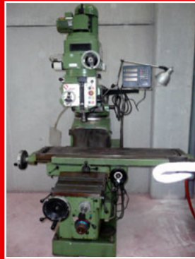
Fresadora de torreta LAGUN, FTV-5-SP, con digitales Heidenhain a 3 ejes
