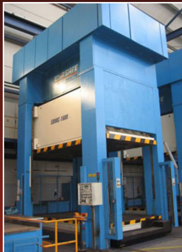
PRENSA LOIRE EDIMC 1.600-60, fuerza 16000 t., mesa 4.900x2.500, 347 cv., hidráulica simple efecto superior
