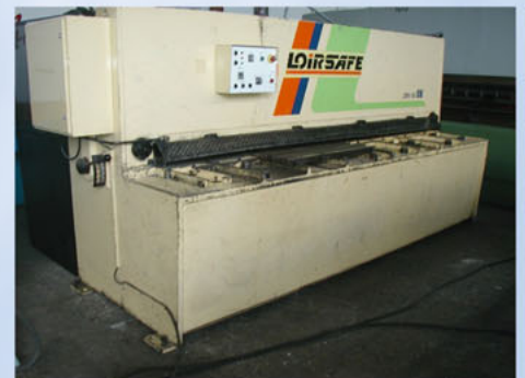
Cizalla LOIRE mod. CHVT-103 de 3000 x 10 mm. Marcado CE.
