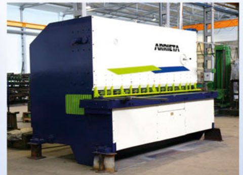
Cizallas Arrieta de 3050 x 13 mm y 3050 x 20 mm.
