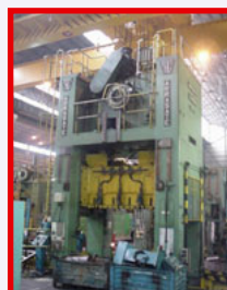
Prensa de doble montante ARRASATE de 400 Tn.
