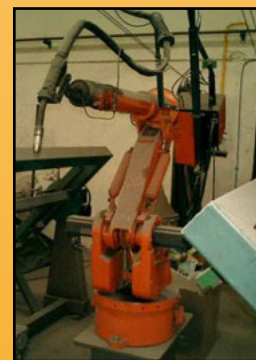
ROBOT ABB CNC 8 EJES CONTROLADOS 2 MESAS POSICIONADORAS
