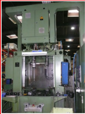
Bruñidora vertical de interiores NAGEL, 2 husillos, con control de posición
