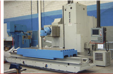
Fresadora CNC ZAYER 30KF 3000. Cabezal 45°. Motor 37kw. Mesa 3.000x1.000
