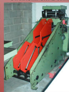
Devanadera-Enderezador 2Tn. x1250 Ø x 330x 3 mm.
