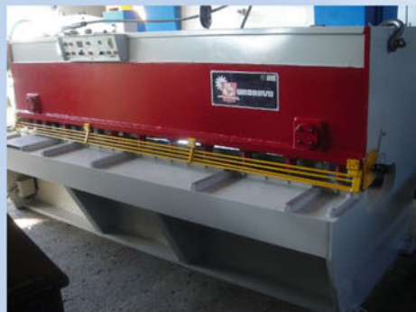
Cizalla CASANOVA mod. VC-6 de 3100 x 6 mm.
